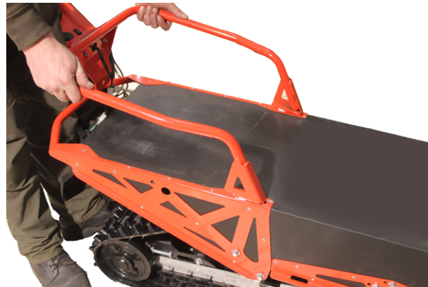
27. Снимаем багажник, потянув на себя и вверх
