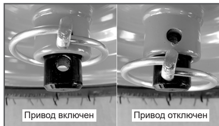
Рис.26 Перестановка шплинта на левом колесе
